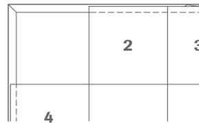
Jetzt misst man die **Platte 1** (Eckplatte) genau aus. Dazu nimmt man das Maß der Öffnung von der eingebauten **Platte 2 bzw. Platte 4** bis zur Wand. An beiden Wandanschlussseiten schneidet man die **Platte 1** (Eckplatte) um ca. 10 mm kürzer.
