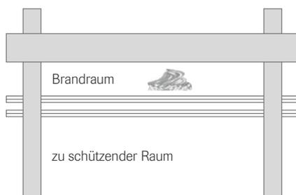
Im Deckenhohlraum müssen die Versorgungsleitungen geschützt sein – unten die Fluchtwege. Dafür haben wir selbstständige Brandschutzeinheiten entwickelt. Damit werden Werte der Feuerwiderstandsklasse EI 30, F 30 bis F 90 erreicht. Das bedeutet, dass unter dem Brand liegende Rettungswege bis zu 90 Minuten geschützt werden. Genauso lange werden die Versorgungsleitungen geschützt, falls der Brand im Raum entsteht.
