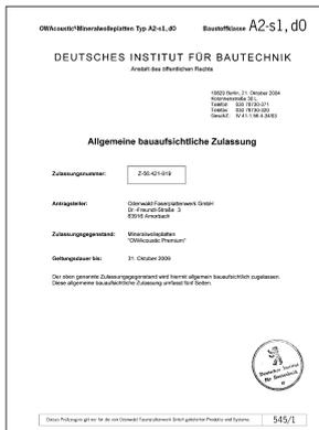
Die Zugehörigkeit zum Brandverhalten **nicht brennbar** muss durch eine allgemeine bauaufsichtliche Zulassung des DIBE (Berlin) nachgewiesen und durch laufende Güteüberwachung gewährleistet sein. Es dürfen nur Baustoffe verwendet werden, die mit einem amtlichen Prüfzeichen versehen sind.
