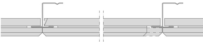
Die quer zum Z-Profil verlaufenden Plattenkanten sind mit auszustei-fenden L-Profilen (Nr. 24) zu versehen. Bei Paneelplatten ist teilweise eine bauseitige Nachnutzung erforderlich.
